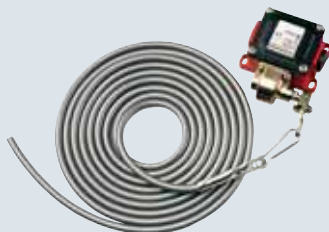
Plastmassist nõõriga nõõrlülitid Paigaldus võimalik horisontaalselt või vertikaalselt, alumiiniumist survevalukorpuses, IP 65, nõõri pikkus 4 m
