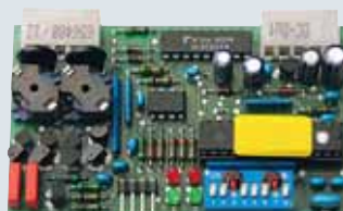
Magnetkontuuri kontrollerseade Trükkplaat 1 või 2 kanaliga, sobilik 2 eraldi magnetkontuuri jaoks, magnetkontuuri kaabel ei kuulu komplekti
