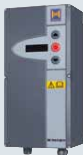
BK 150 FU E H Sagedusmuunduriga juhtseade plastmassist korpuses, IP 54, ühe faasiga, 230 V
