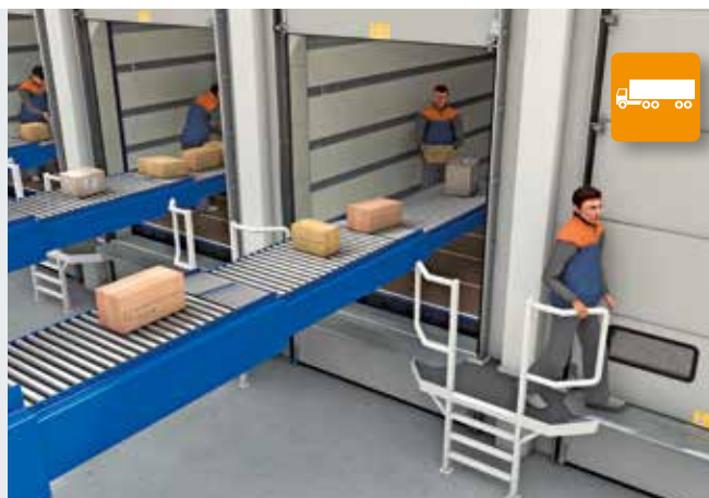
Veoautode ja vahetuskonteinerite laadimisel jääb paneelisokkel koos teenindusalaga avatud ukse korral pörandale.
