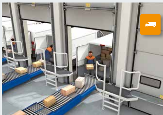
Kaubikuid laaditakse hoone pörandatasandil. Selleks avatakse üks terviklikult koos soklipaneeliga.
