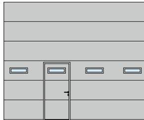
SPU F42, SPU 67 Thermo lamellaken tüüp D jalgvärava asetus vasakul
