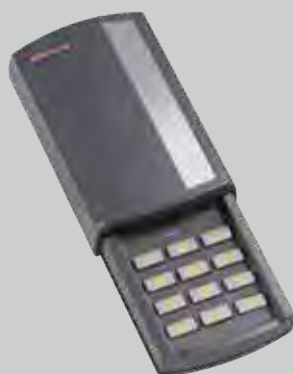
Raadio-koodlüliti FCT 10 BS 10 funktsiooniga, valgustatud nuppudega ja kaitsekaanega
